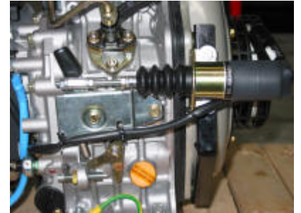
Dieselmootoriin asennettu ohjaus-solenoidi
