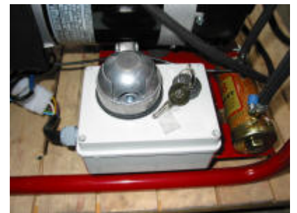
Diesel-mootorin ohjauskeskus sisältää ohjausliittimen, paikalliskäyttöavaimen sekä tarvittavat välireleet laitteen ohjaamiseksi.
