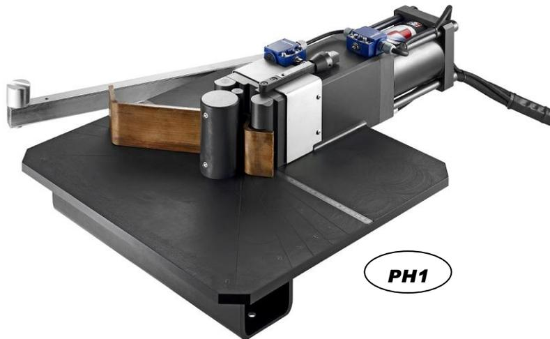
Machine simple à utiliser, avec butée de déclenchement électrique pour les plis répétitifs, angles principaux gravés sur le plateau de travail, bras support articulé pour maintien des barres. Actionnement par centrale électrohydraulique CME (idem "Cisabarre").
