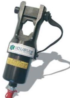
La tête de sertissage XH250 se connecte à un groupe hydraulique 700 bar, par flexible et coupleurs haute-pression, pour des utilisations semi-intensives ou intensives (selon le groupe utilisé). Cette solution permet d'interchanger différentes têtes de sertissage ou de coupe-câbles, selon les capacités et applications. Voir "groupes" - pages 86>95.
